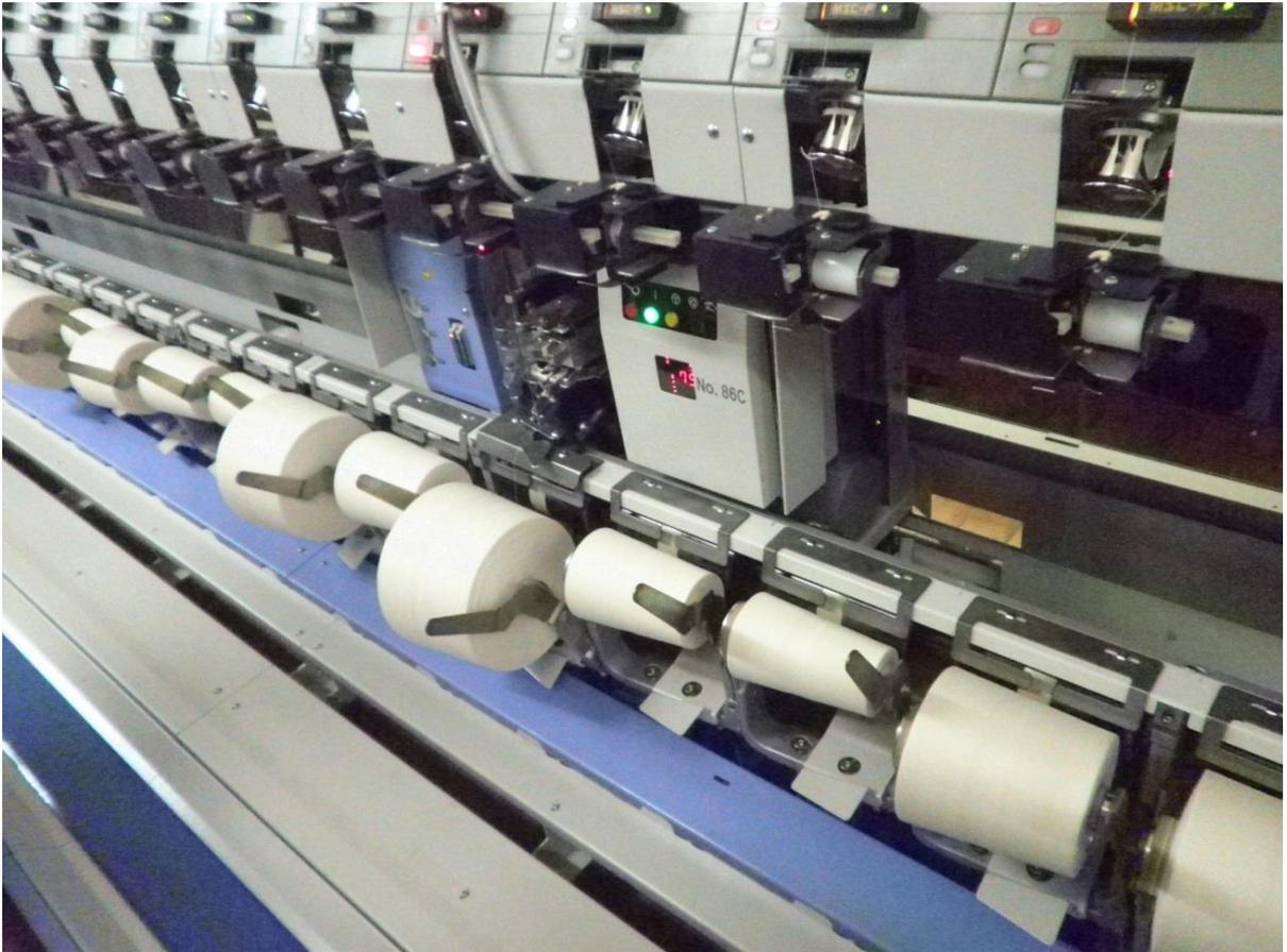
Figura 8 – Máquinas elaborando os cones de fios.
